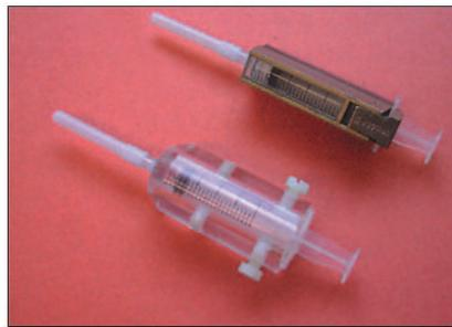
Εικ. 1 Σύριγγες εντός μολύβδινων και ισχυρών διάφανων πλαστικών καλυμμάτων που χρησιμοποιούνται για την έγχυση ραδιοισοτόπων. Η ενέργεια που εκλύεται από το ισότοπο υπαγορεύει και τον τύπο καλύμματος που απαιτείται.
